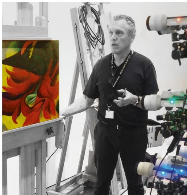
Abbildung 1: Kunst richtig zu konservieren bedeutet für Dale Kronkright (rechts), die Werke auch vor Schwingungsbeanspruchung während des Transports zu schützen. Hier verwendet er ein MPV-800 Multipoint Vibrometer von Polytec, um die Schwingungseigenschaften von Leinwänden zu analysieren.
