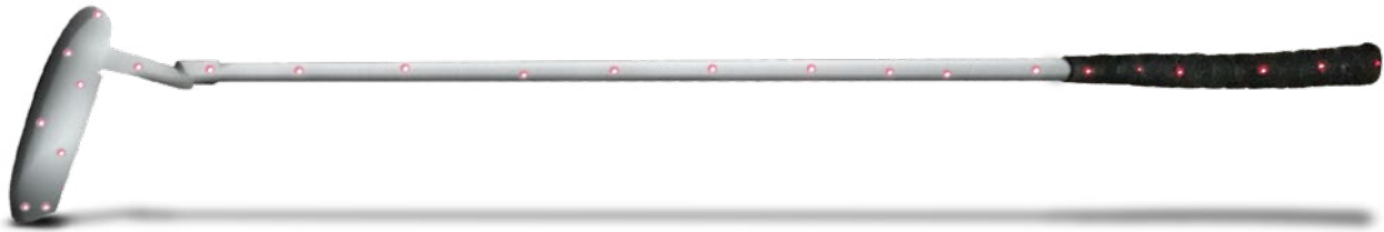
Abbildung 2: Der getestete Putter ist hier mit 24 gut sichtbaren Lasermesspunkten dargestellt.
