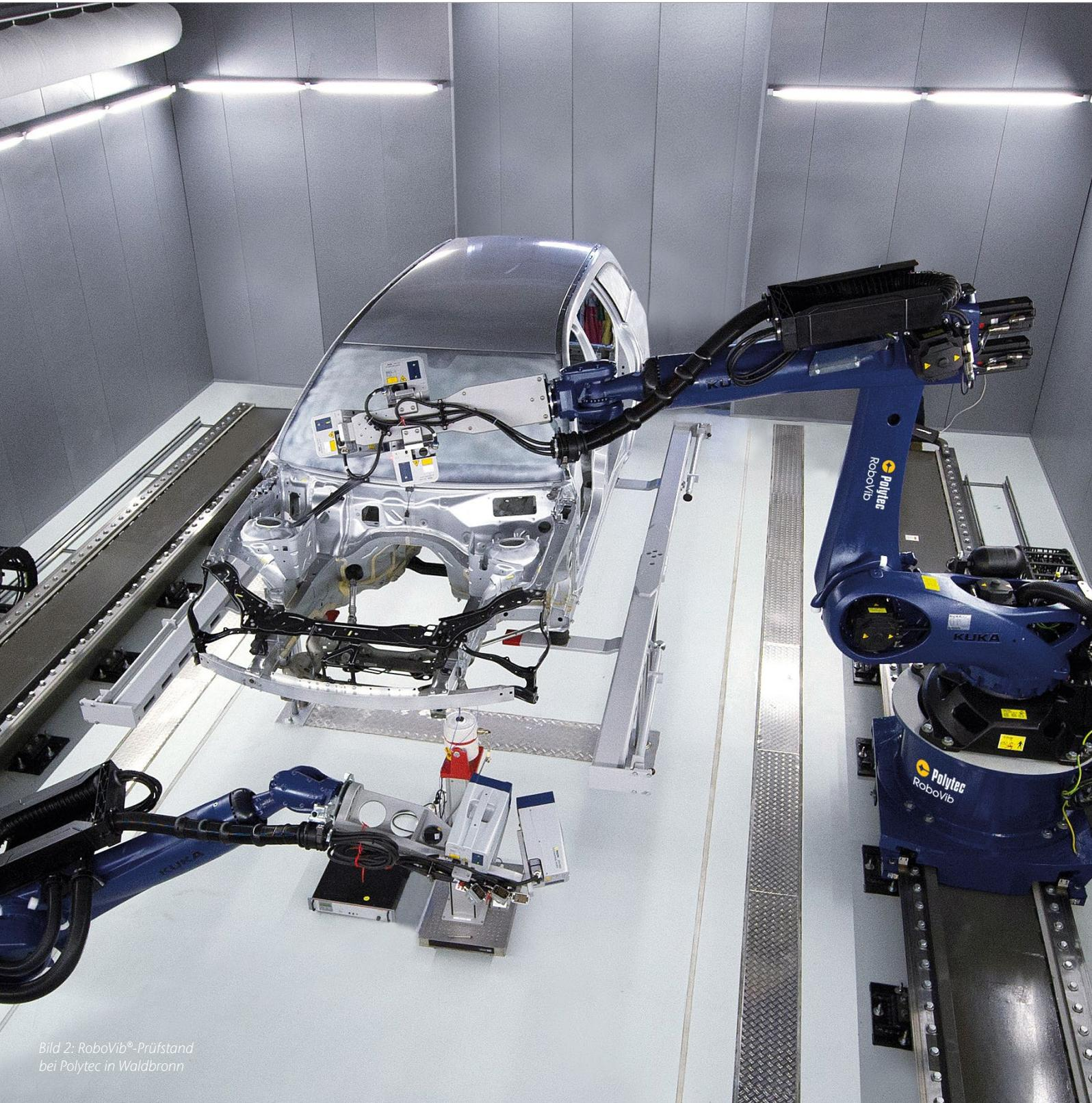
*Bild 2: RoboVib®-Prüfstand
