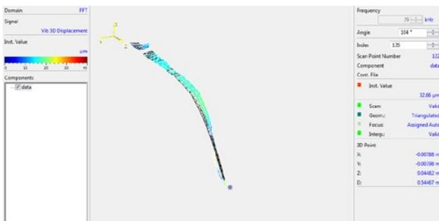
Abbildung 4: Schwingform des PS-Instruments bei aktivem Ultraschall.
