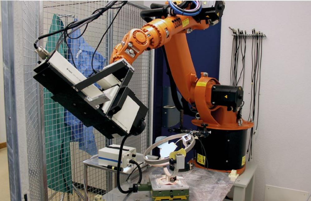
Bild 2: Versuchsaufbau: Der Roboterarm ermöglicht das Anfahren der gewünschten Position des Scanning Laservibrometers, sodass die Schwingungen des sich im Schläfenbein befindenden Steigbügels erfasst werden können.
