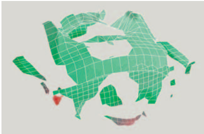
Bild 3: Betriebsschwingform eines Bremsstatts, gemessen mit dem Scanning Vibrometer
