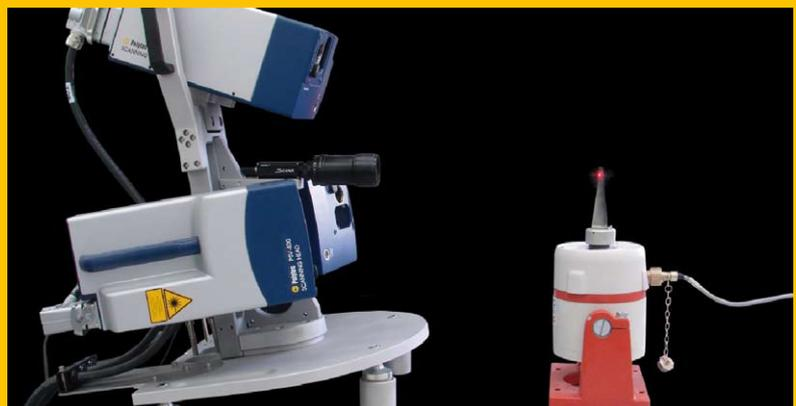
Bild 2: 3D-Scanning Vibrometer beim Test an einer Turbinenschaufel
