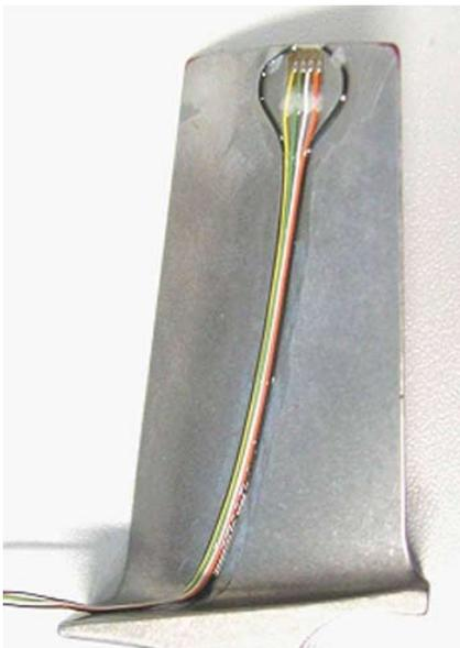
Bild 1: Mit DMS instrumentierte Turbinenschaufel
