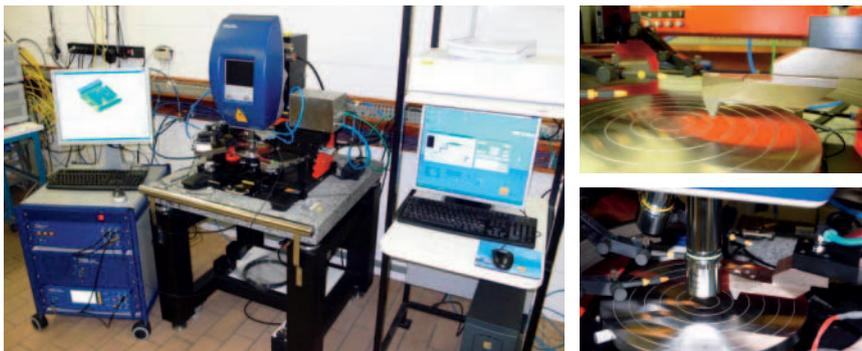
Bild 1: MSA-500 und Drucklufteinheit (rechts: Nahansicht der Druckluftdüse)
