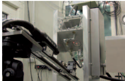
Bild 2: Ventiltriebsuntersuchungen an einer Ein-Ventil-Attrappe in der Vorentwicklungsphase eines Motors
