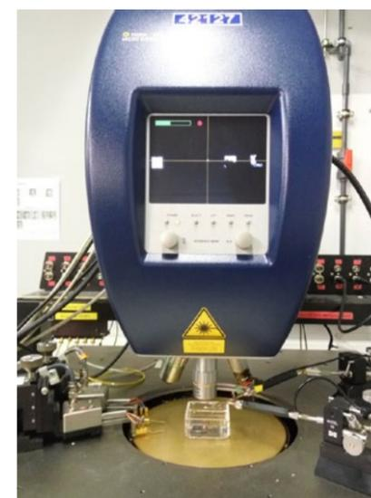
Ein von einem Impulsgenerator (60 V) kommender, 50 ns langer Impuls wirkte auf das Pad, das an die Bodenelektrode der cMUT-Zelle angeschlossen war. Eine 160-V-Gleichstromvorspannung, was 60 % der theoretischen Nennspannung entspricht, wurde an das andere Pad angelegt.
