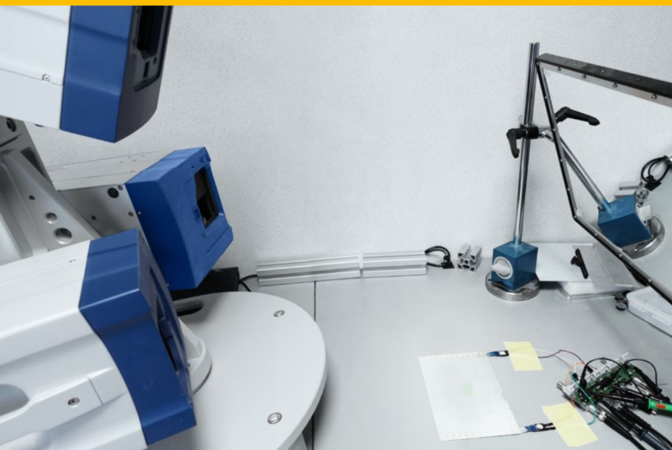
3 Installation d'essai en laboratoire, avec balayage automatique de la surface de l'échantillon pour obtenir des données de vibration 3D
