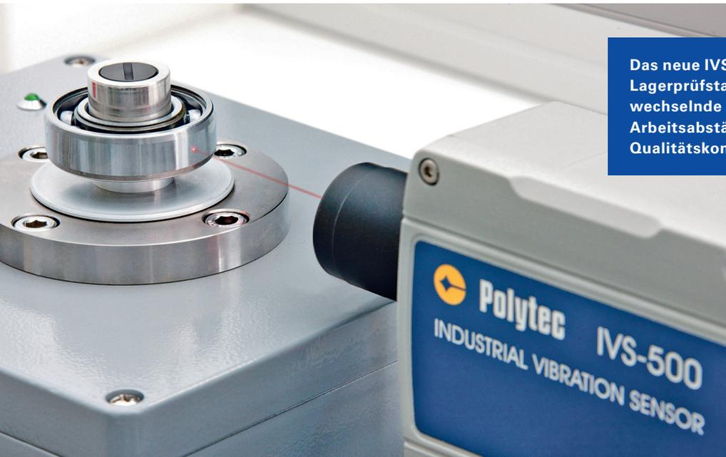
Das neue IVS-500 Industrie-Vibrometer (hier in einem Lagerprüfstand) adaptiert sich automatisch an wechselnde Bauteile, Baugruppen und alternierende Arbeitsabstände für berührungsfreie akustische Qualitätskontrollen in der Fertigung.
