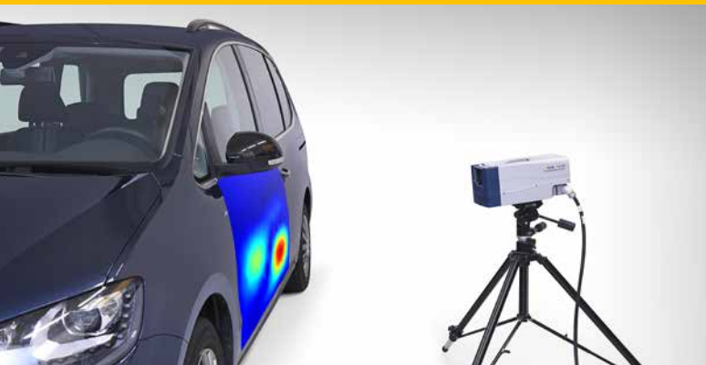
Flächenhafte Schwingungsmessung mit einem Scanning-Vibrometer
