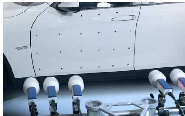
Zeitsynchrone optische Schwingungsmessung mit einem MPV Multipoint Vibrometer: Berührungslos transiente und instationäre Vorgänge erfassen wie Akustiktests beim Türzuschlagen.
