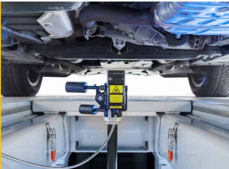
Rotationsvibrometer ermitteln torsionale Eigenresonanzen des Antriebsstrangs auf dem Rollenprüfstand, hier am IPEK des KIT Karlsruhe Institute of Technology.
