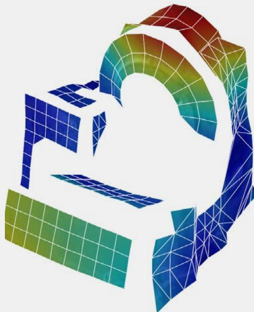
6 Schwingform der Getriebeglocke bei 1829 Hz
