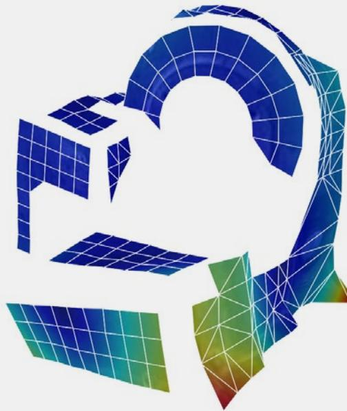
5 Schwingform der Getriebeglocke bei 1102 Hz
