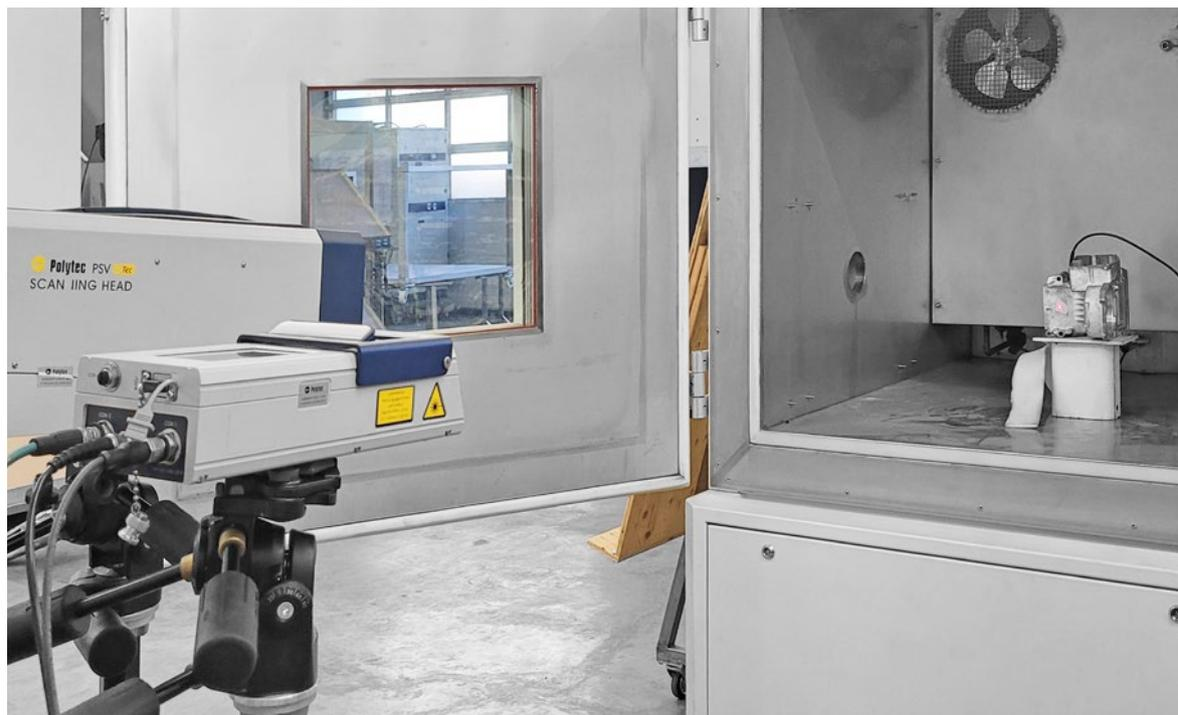
**Präzise Schwingungsmessungen in Klimakammern**
