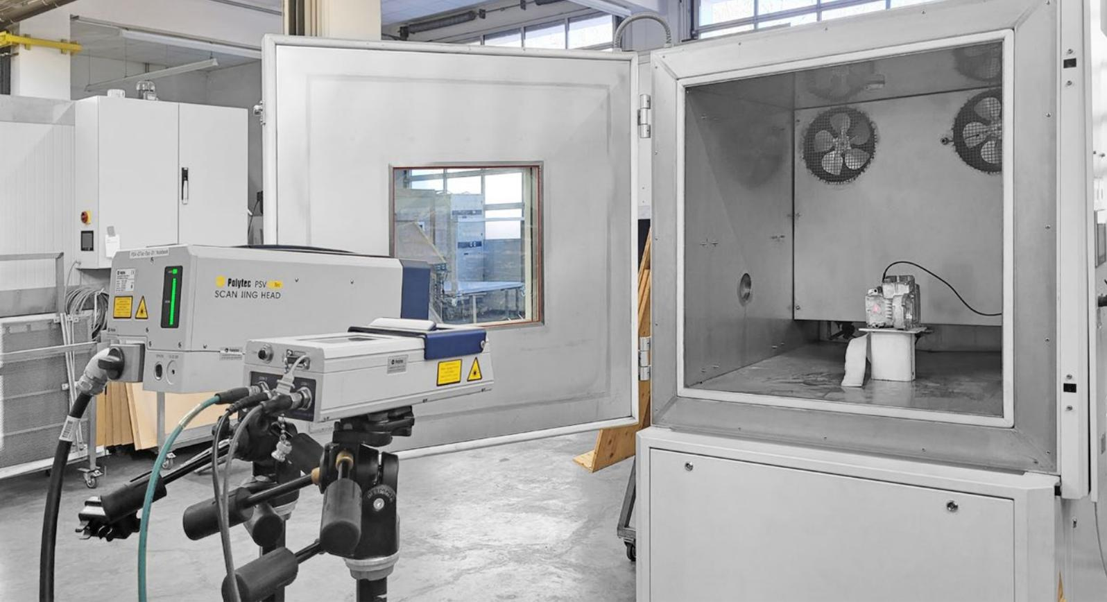
1 Messung auf Getriebeglocke innerhalb einer Klimakammer bei geöffneter Tür mit einem QTec Scanning Vibrometer und einem VibroGo
