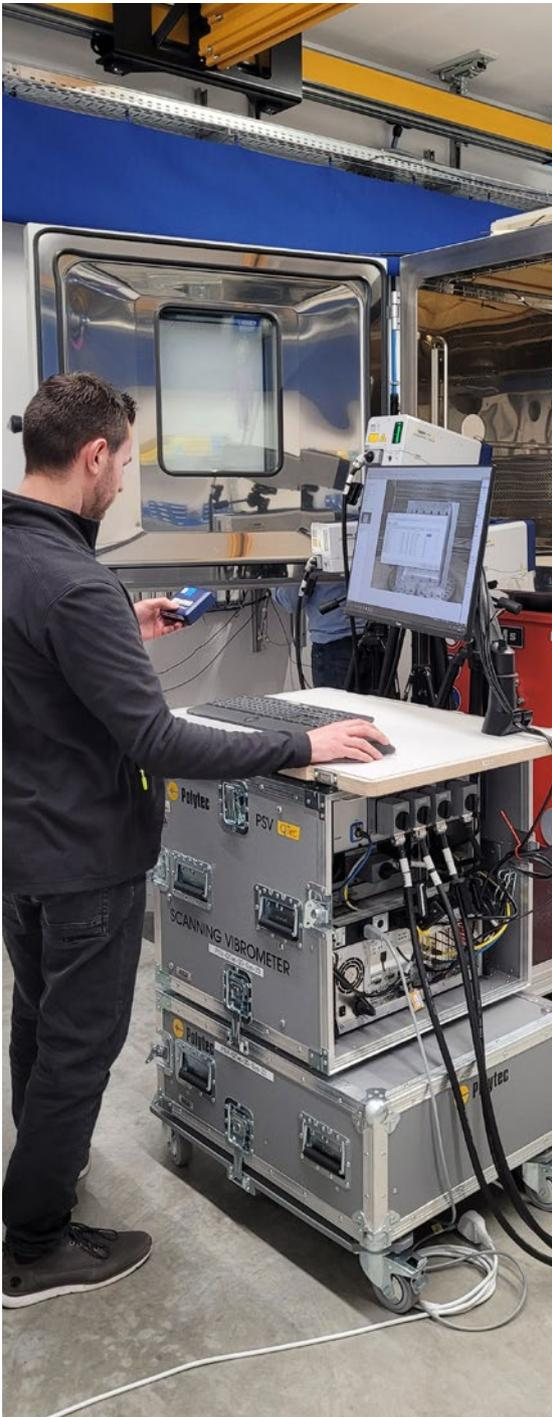
Die Bestimmung der Eigenfrequenzen von Bauteilen mittels Shakermessungen oder automatischem Modalhammer ermöglicht die zuverlässige Identifikation von Schwingformen.
