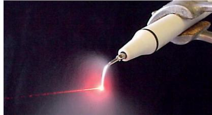
Der Laser des Scanning Vibrometers vermisst die Oberfläche eines zahnmedizinischen Ultraschallscalers.
