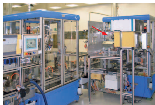
Bild 1: Automatischer Prüfstand für Motor-Pumpen-Aggregate (MPAs). Pfeil: IVS Vibrometer
