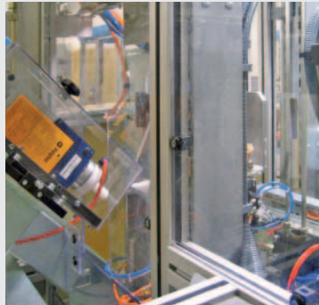
Bild 3: Schutzgehäuse des IVS Vibrometers mit Freiblasvorrichtung
