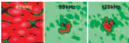
Zerstörungsfreie Prüfung einer Delamination in einem Verbundwerkstoff
