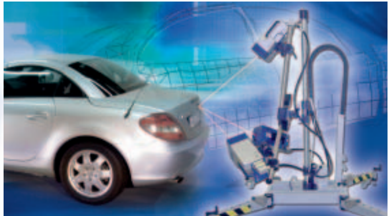
3D-Scanning-Messung der Strukturdynamik einer Autokarosserie
