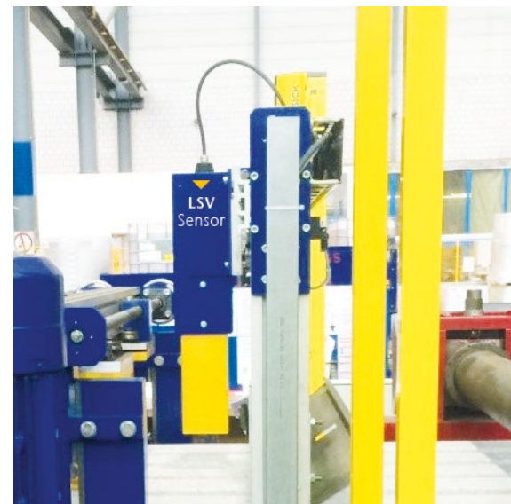
Bild: LSV-Messung auf Vlies-kaschierten Trapezblechen
