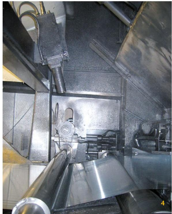
1 LSV mit Kühl- und Schutzgehäuse zur Messung der Gießgeschwindigkeit und zur Ablängsteuerung in einer Knüppelgießanlage
