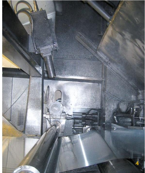
1 LSV avec des boîtiers de protection pour mesurer la vitesse de coulée et la longueur dans une coulée de billettes
