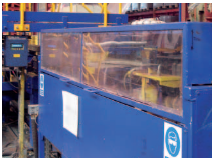
Zwei der bei Mueller Copper Tube in Bilston (England) installierten LSV-300 Surface Velocimeter für die Zuschnittsteuerung
