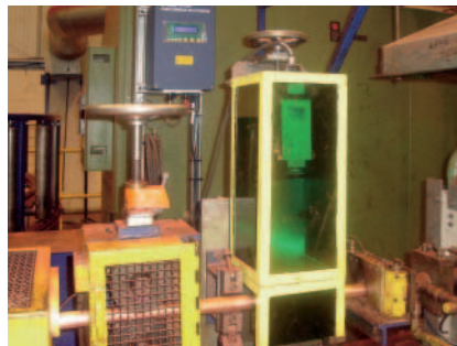
Zwei der bei Mueller Copper Tube in Bilston (England) installierten LSV-300 Surface Velocimeter für die Zuschnittsteuerung
