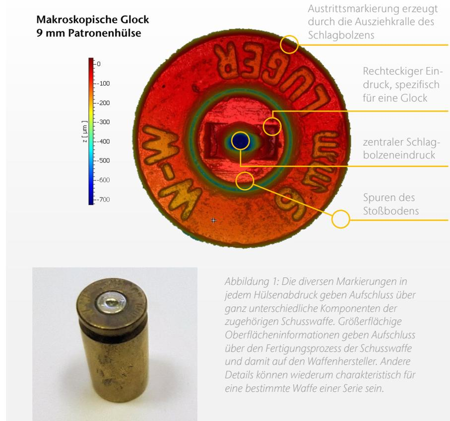
In dieser Arbeit wurden die Informationen der Oberflächentopografie mit einem TopMap Pro.Surf von Polytec ermittelt. Dieses optische Oberflächenmesssystem ist ein Kohärenz-Scanning- bzw. Weißlicht-Interferometer mit großem Gesichtsfeld, was Projektileanalysen in einer einzigen Messung ermöglicht und die berührungsfreien 3D-Oberflächenanalysen erheblich beschleunigt. Mit einer z-Auflösung im Nanometerbereich entgeht dem TopMap Pro.Surf kein wichtiges forensisches Detail. Während der
