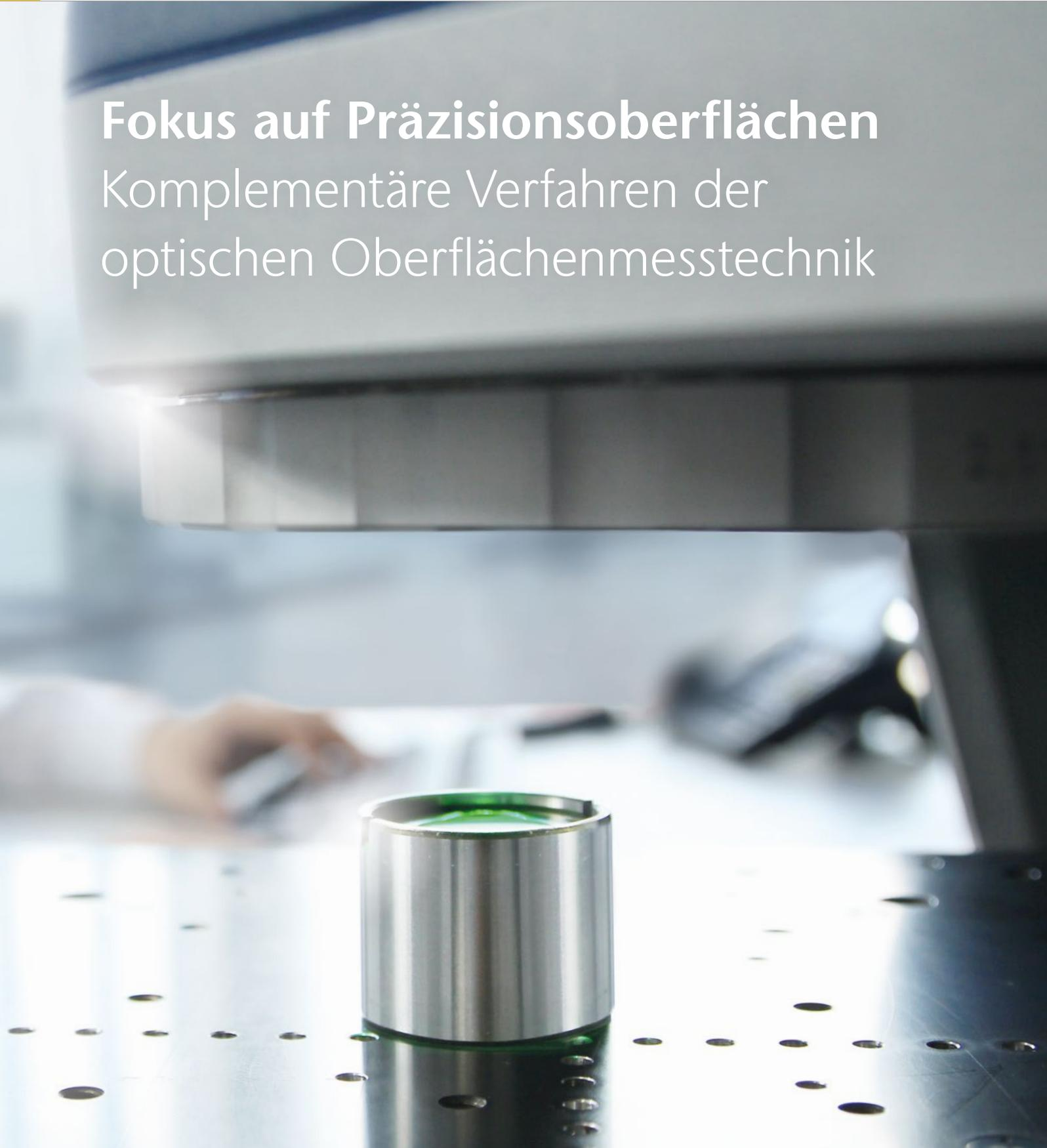
Viele Aufgaben der Oberflächenmesstechnik, bei denen taktile Messverfahren in den letzten Jahren an ihre Grenzen kommen, werden bereits heute durch berührungslos arbeitende optische Messtechnik gelöst. Insbesondere die Verbesserung der Computer-Rechenleistung ermöglicht die Verarbeitung der hierbei flächenhaft anfallenden Oberflächenmessdaten mit hoher Auflösung und in hoher Geschwindigkeit.
