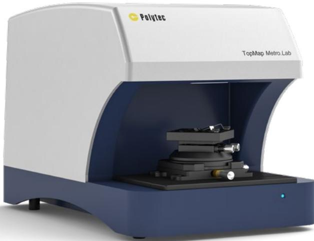
Das TopMap Metro.Lab von Polytec ist ein hochpräzises Weißlicht-Interferometer (Coherence Scanning Interferometer) mit einem großen vertikalen Messbereich. Berührungslose Messungen der Ebenheit, Stufenhöhe und Parallelität an großen Flächen und Strukturen selbst weicher und filigraner Materialien sind daher ideale Anwendungen für das TopMap Metro.Lab.
