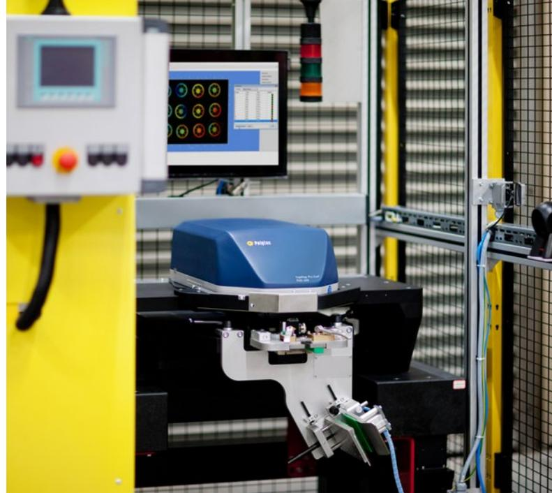
Anwendungsspezifische Lösungen zur Qualitätskontrolle in der Produktionslinie (mit integriertem Barcode-Scanner und automatischer Bauteil-Lageerkennung)
