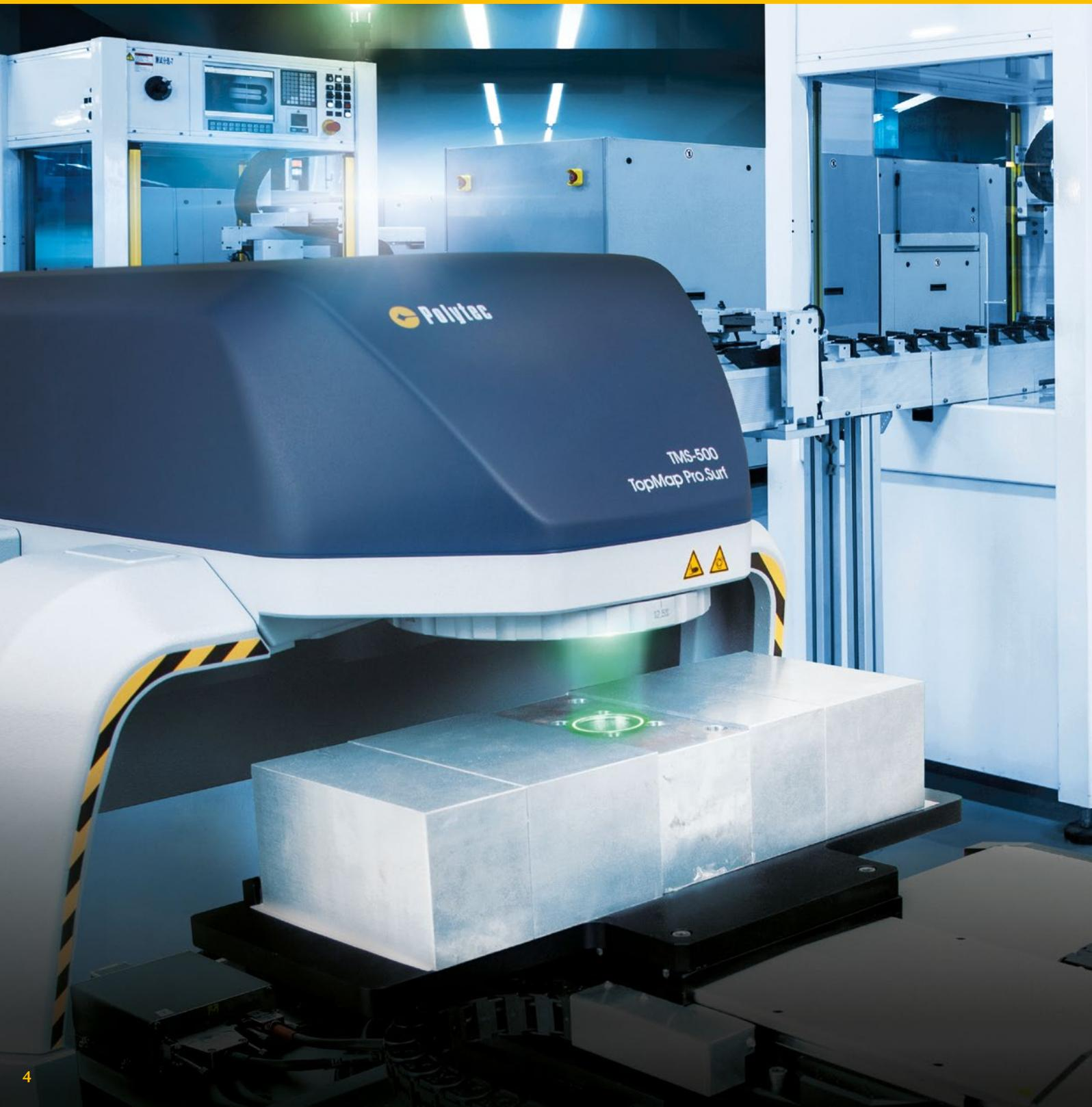
Moderne Weißlicht-Interferometer von Polytec nutzen die Interferenzeffekte, die bei der Überlagerung des vom Messobjekt reflektierten Lichts mit dem von einem hochgenauen Referenzspiegel zurückgestreuten Licht auftreten. Durch Abfahren mit einem Spiegel wird die Höhe des Objektes gescannt.
