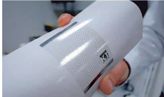
Tintenstrahl Druck von silberhaltiger leitfähiger Tinte auf Papier
