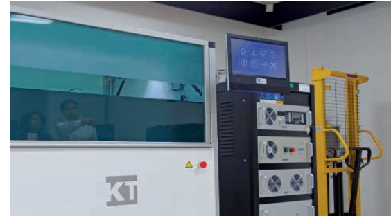
Der Drucker (links) und die Steuereinheit der Sinteranlage (rechts)
