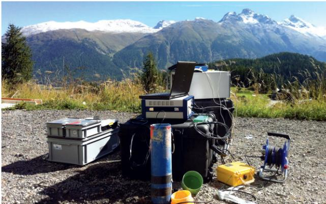
Bild 3: Ein Bohrloch mit faseroptischen Sensoren bestückt. Diese instrumentierte Bohrung befindet sich in einem Kriechhang und soll eine mögliche Scherfläche detektieren
