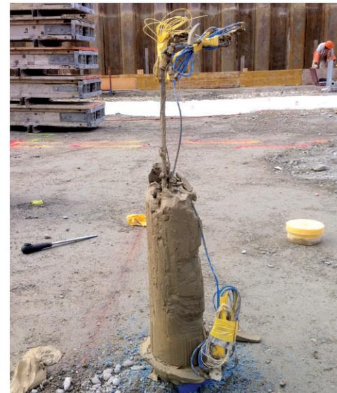
Bild 1 (oben): Bedingungen, die ein faseroptisches Sensorkabel überstehen muss. Im Bild ein Versuch mit mehreren Sensorkabeln unter Baustellenbedingungen
