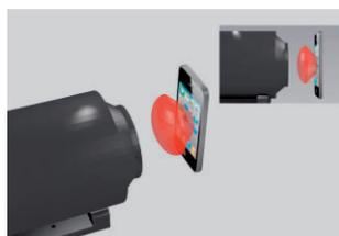
Aktuelle Fourier-Technologie: Zeitgleiche Messung mehrerer 100.000 Messpunkte mittels Viewing-Angle- bzw. Uniformity-Messsysteme
