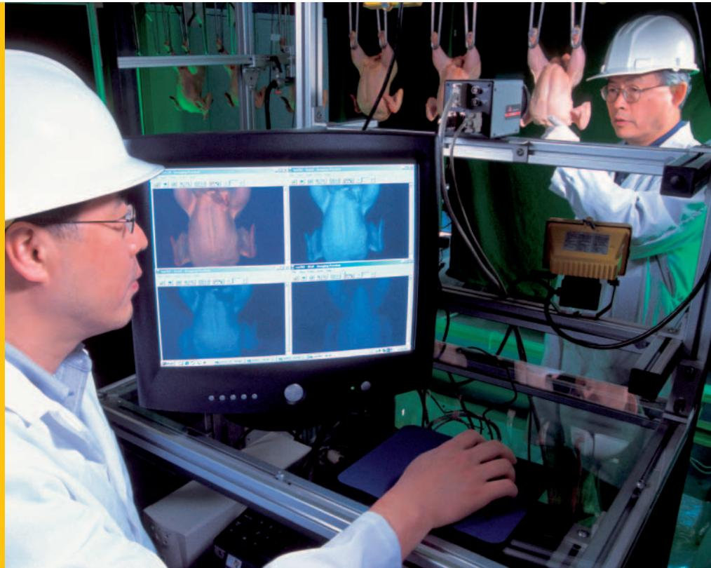
Einrichtung einer HSI-Prüfstation zur Kontrolle von Geflügel
