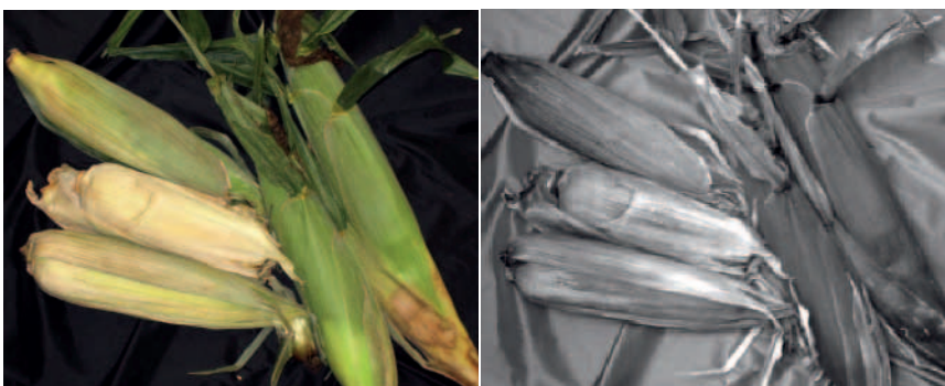
Bild 4: Maiskolben mit unterschiedlichem Feuchtegehalt in Normalansicht (links) und im SWIR-Bereich (rechts). Helle Partien sind eher trocken, dunkle eher feucht
