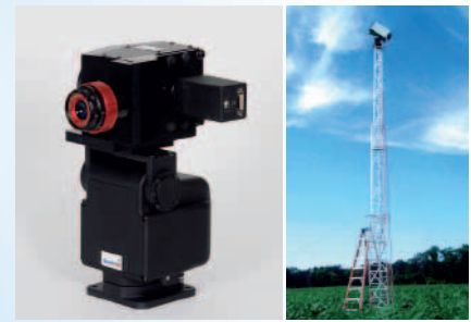
Bild 2: Spektralanalysen können aus der Luft oder von stationären Sensoren aus erfolgen – frei schwenkbar oder mit fester Blickrichtung
