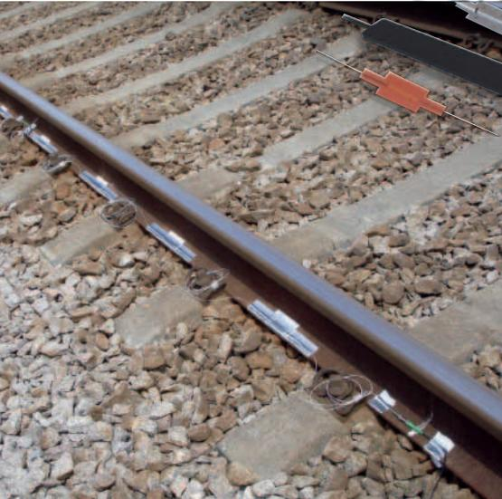
**Bild 2: Versuchsanordnung von Dehnungssensoren an Eisenbahnschienen**
