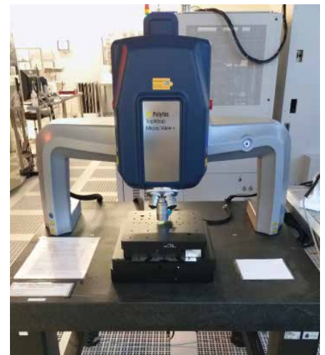
Das Weißlicht-Interferometer im Reinraum: Es erkennt feine Strukturdetails über den gesamten Messbereich.
