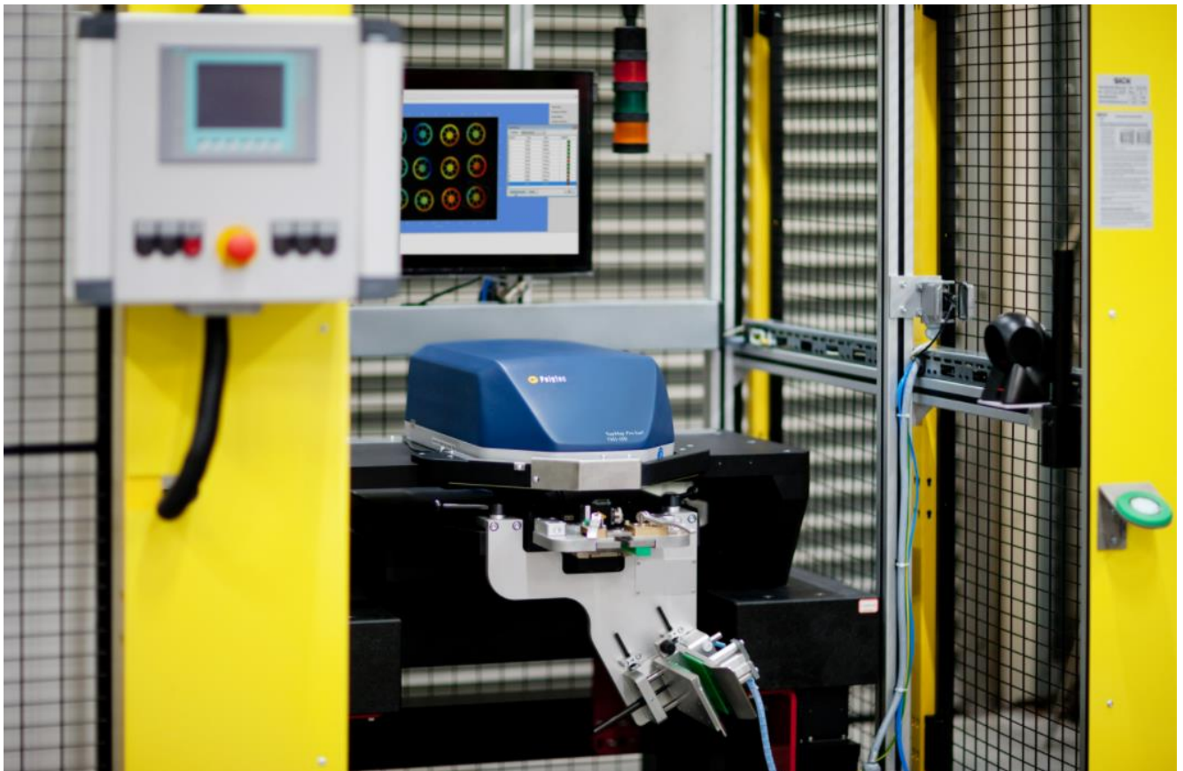
Abb. 3: Effiziente in-line und end-of-line Qualitätskontrollen in automatisierten Produktionen mit automatischer Prüflingsmuster- und Lageerkennung und Durchmessen mehrerer Prüflinge in einer Aufnahme.
