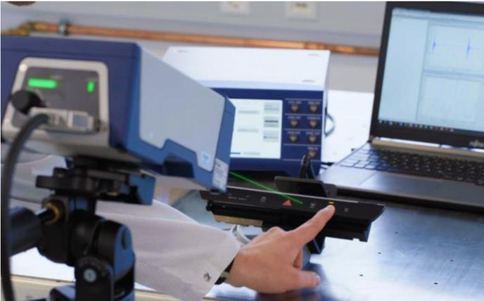
Bild 1: Laserbasierte Schwingungsmessung mit VibroFlex Xtra ist optimal für dunkle, bewegte oder rotierende Oberflächen – hier zur Untersuchung des haptischen Feedbacks einer Automobil-Bedienleiste.
