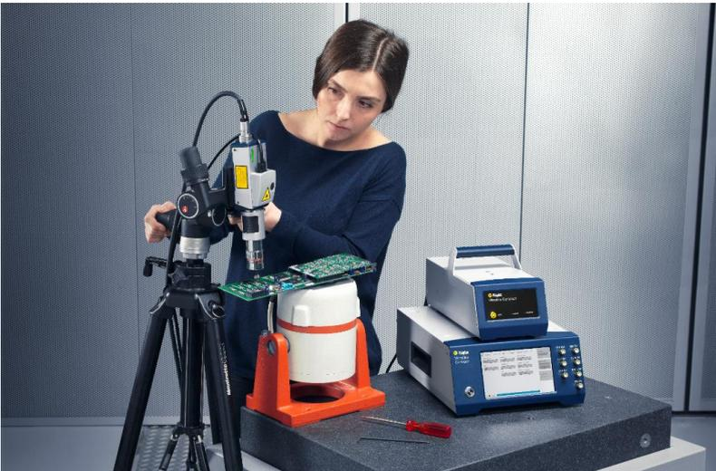
Bild 2: Berührungsfrei Schwingungen selbst an feinsten Strukturen messen, z.B. für Zuverlässigkeitstests an Elektronikbauteilen mit dem VibroFlex Compact mit Mikroskopoptik, koaxialer Beleuchtungseinheit und HD+ Kamera zur visuellen Kontrolle und Dokumentation
