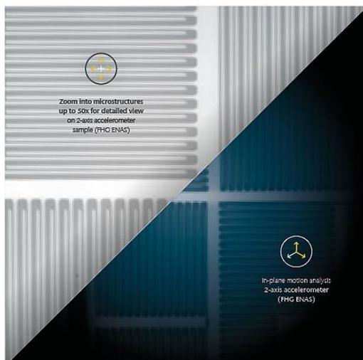
*Bild: Analyse der Bewegung in der Bauteilebene mit bis zu 50x Zoom für einen detaillierten Einblick in verkapselte MEMS*
