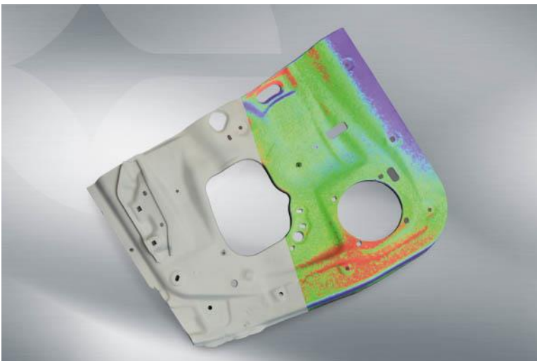
Bildunterschrift: Falschfarben-Darstellung der Abweichung zwischen CAD-Zeichnung und Objekt.
