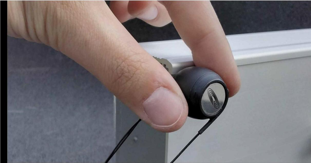
Der Qsources Qlws LightWeightShaker ist selbsttragend und kann in jeder Position am Testobjekt angebracht und zur reproduzierbaren Schwingungserregung für Modaltests eingesetzt werden.
