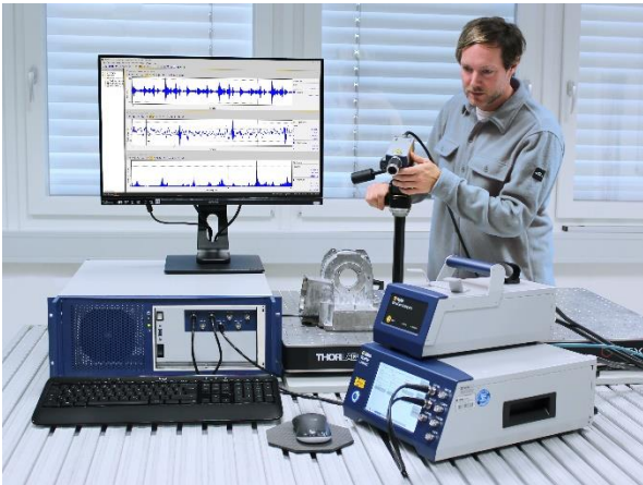
Schwingungsmessung mit leistungsfähiger Datenanalyse: Modulares Laservibrometer VibroFlex mit Datenerfassung VibSoft-PRO von Polytec
