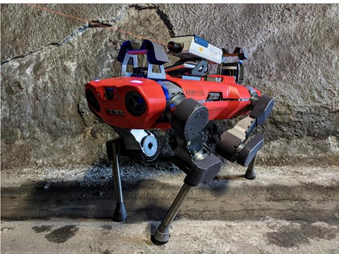
Bild 2: VibroGo auf einem ANYmal - Roboter der Firma ANYbotics aus Zürich
