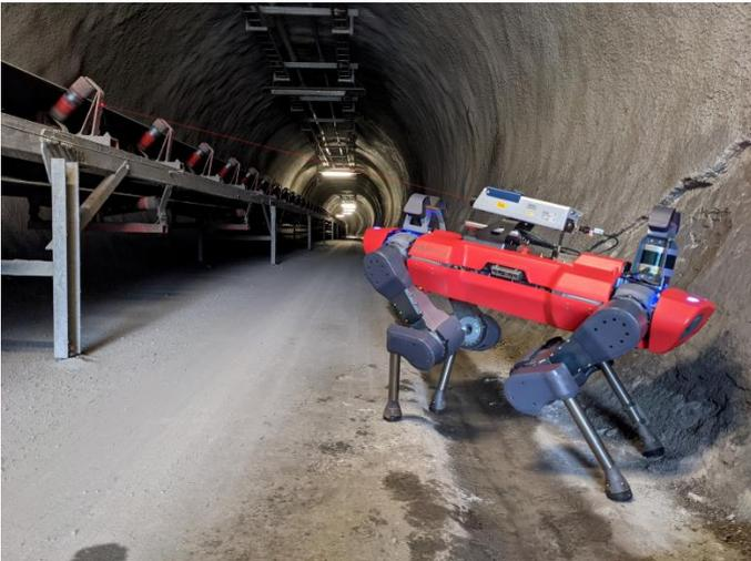
Bild 1: VibroGo auf einem ANYmal für eine autonome Zustandsüberwachung auf Walzlagern
