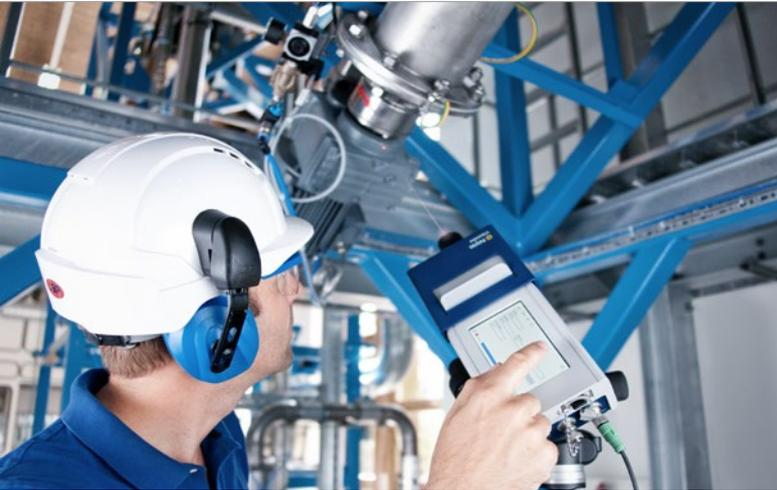
Abbildung 1: Zustandsüberwachung: Überall, wo keine feste Sensorik montiert werden kann, lassen sich technische Anlagen und Bauteile berührungslos aus der Distanz (z. B. auch in Gefahrenbereichen) kontrollieren.
