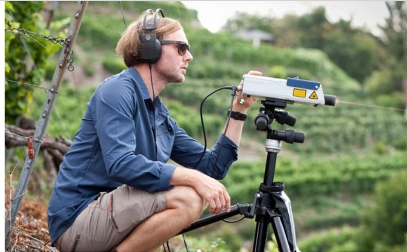
Abbildung 2: Für Botanik, Entomologie, Bionik oder Schädlingsbekämpfung sind tragbare Laservibrometer oftmals das einzige Messgerät der Wahl.
