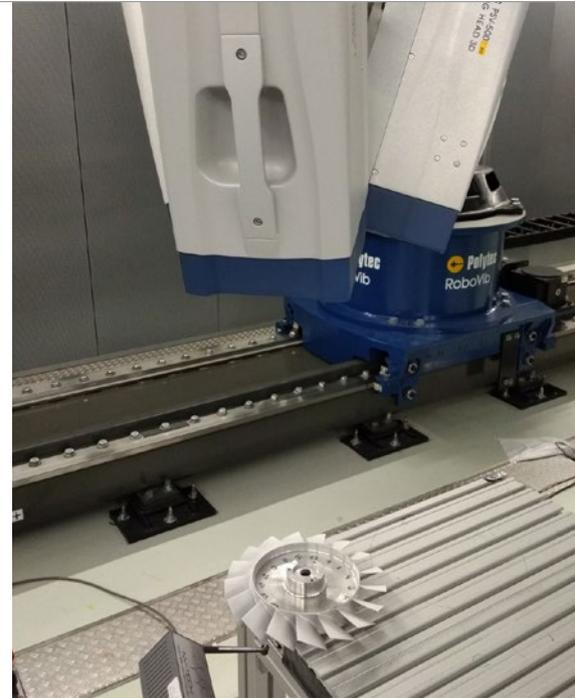
Abbildung 1: Messaufbau einer Blisk mit 240 mm Durchmesser, gemessen mit einem PSV-3D Scanning Vibrometer.
