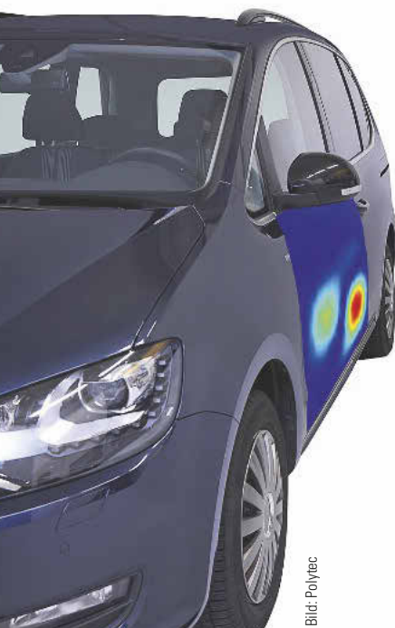
Aeroakustik-Test per Scanning-Vibrometer: Die detektierten Schwingformen unterstützen die Qualitätssicherung in der Automobilkonstruktion
