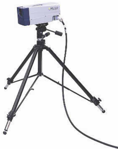
Aeroakustik-Test per Scanning-Vibrometer: Die detektierten Schwingformen unterstützen die Qualitätssicherung in der Automobilkonstruktion
