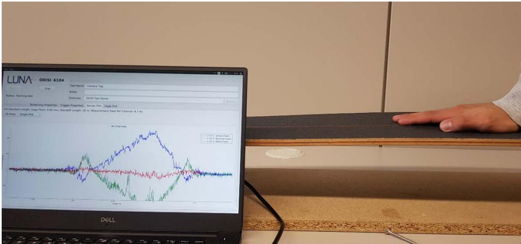
Drückt man von oben auf das Skateboard, so misst das Interferometer ortskontinuierlich die Stauchung an der Oberseite (grüne Kurve), die Dehnung an der Unterseite (blaue Kurve) sowie die neutrale Faser im Innern des Boards (rote Kurve). Mit konventioneller Messtechnik ist dies nicht möglich.
