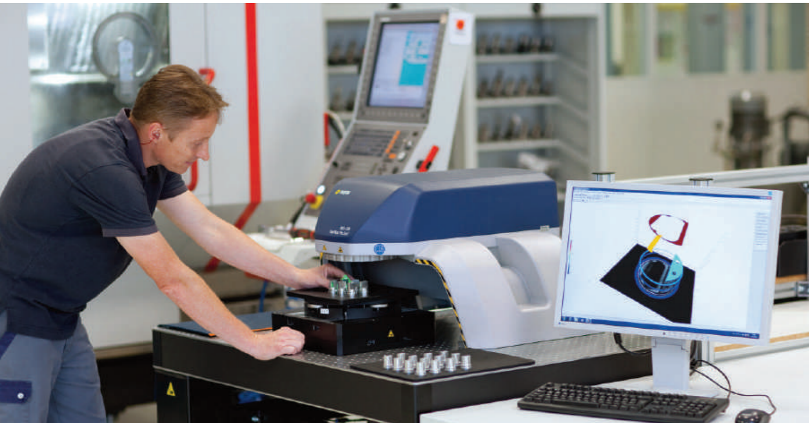
Bild 1 | Optische Oberflächenmesstechnik dient der zuverlässigen Unterscheidung zwischen IO/NIO-Bauteilen. Um die verschiedenen Geräte- und Verfahrensspezifikationen miteinander vergleichen zu können, hilft die Initiative 'Faires Datenblatt'.
