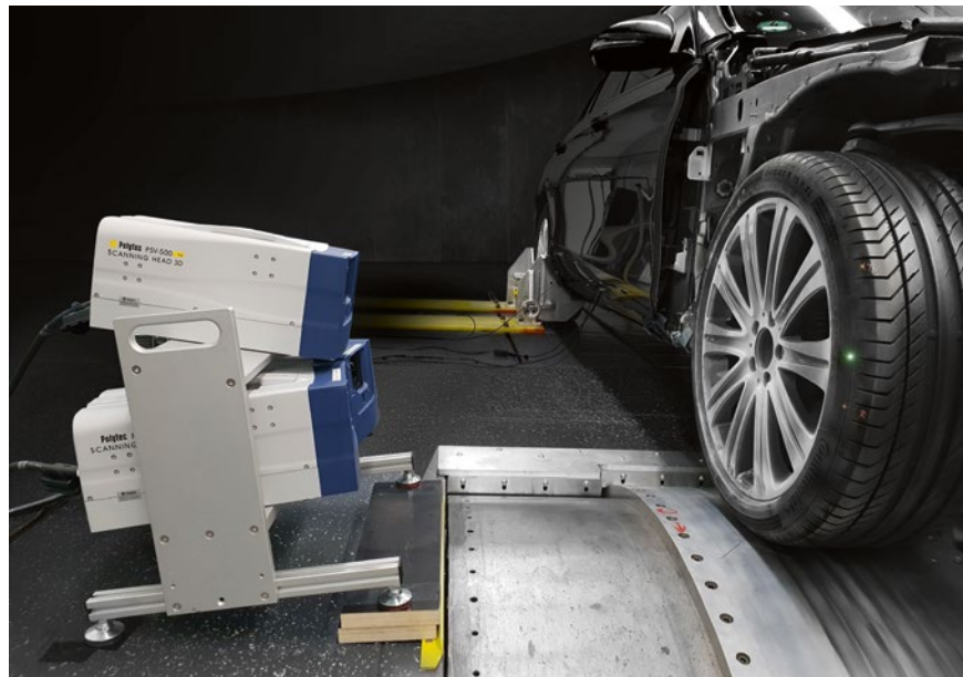
BILD 2 Versuchsaufbau mit 3-D-Scanning-Laser-Doppler-Vibrometer (links) und Radprüfling auf dem Trommelprüfstand (© Continental)
