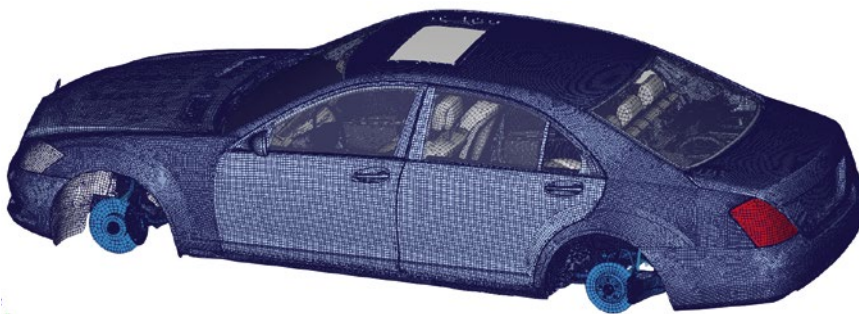
BILD 1 FE-Modell des Fahrzeugs mit circa zwei Millionen Knoten für das Fahrwerk (© Daimler)
