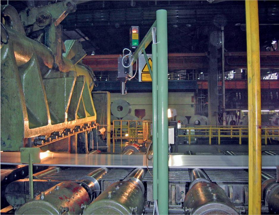
Aluminiumbleche auf einem Rollgang mit LSV-Geschwindigkeitsmessung
