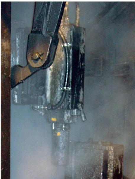
LSV mit Kühlschutzhäuser in einem Walzwerk
