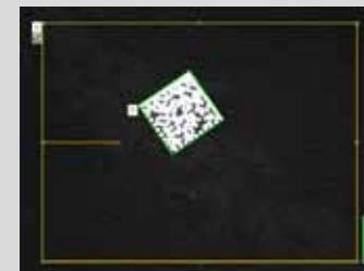
Codelesung auf Solarzellen Auch extrem kleine Codes wie z. B. auf Silizium-Solarzellen oder hoch spiegelnde Codes wie z. B. auf Dünnschicht-Solarzellen können gelesen werden.
