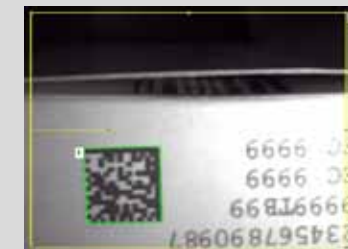
Gedruckte Codes auf Pharma-Verpackungen Es kann zeitgleich nach ECC200 oder Barcodes (z. B. EAN 13) gesucht werden. Neben der Codelesung kann per Objekterkennung die Anwesenheit des Klartextes geprüft werden.
