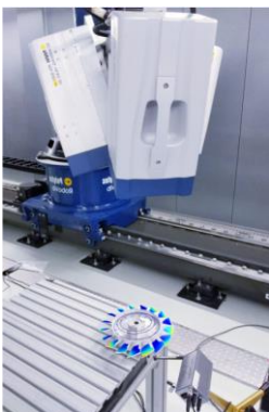
Modaltest ein einem Turbinenläufer (SAM1 und 3D Scanning Vibrometer)
