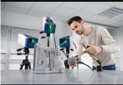
Modaltest mit PSV 3D QTec Laser Vibrometer und automatischer Impulshammeranregung
