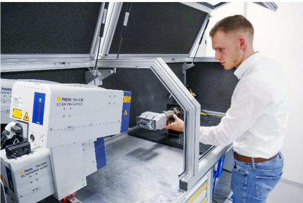
Qualitätssicherung von Sonotroden für das Ultraschallschweißen – ein Makro führt den Bediener durch den Prüf- und Dokumentationsvorgang (Bildquelle: Herrmann Ultraschall GmbH & Co. KG)
