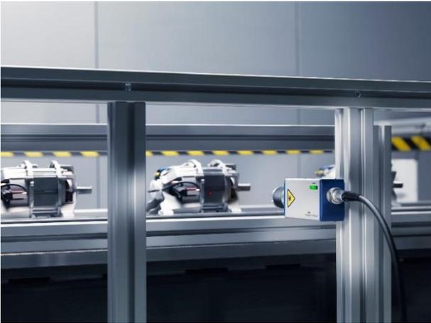
Polytec Laservibrometer können dank ihrer Automatisierungsschnittstelle einfach in Produktionslinien für die vibroakustische Qualitätskontrolle integriert werden.
